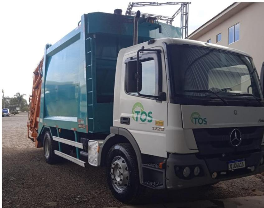
Figura 20 - Caminhão compactador de 15m<sup>3</sup> utilizado na coleta de RSC
