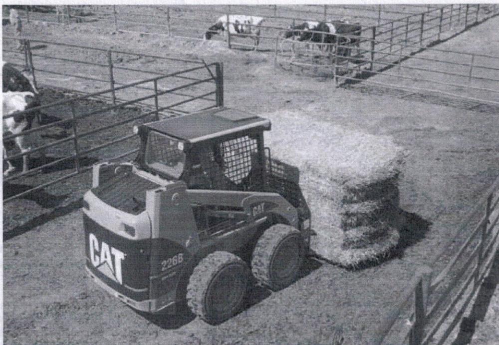
tamento e inclinação da carregadeira, alimentando o circuito para acionar as ferramentas de trabalho e o ventilador de arrefecimento do motor. As máquinas também apresentam sistemas hidráulicos auxiliares padrão para alimentar as ferramentas de trabalho.
